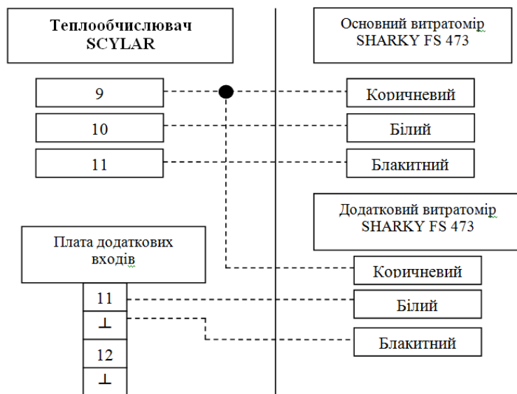
Малюнок 8. Порядок підключення ультразвукового витратоміра SHARKY FS 473 до обчислювача SCYLAR
